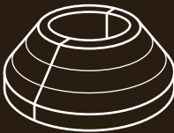
verwarmingsbuisrozet 50 mm (diameter) x 18 mm (hoogte), 16 mm gat 55 mm (diameter) x 20 mm (hoogte), 22 mm gat
